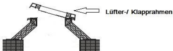
Der Lüfter - / Klapprahmen besteht aus PVC der mit Scharnieren an der einen Seite versehen ist.
