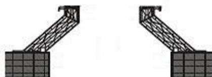
Der Aufsatzkranz wird standardmäßig aus schlagfestem, glasfaserverstärkten Polyesterharz (GF-UP) hergestellt.
